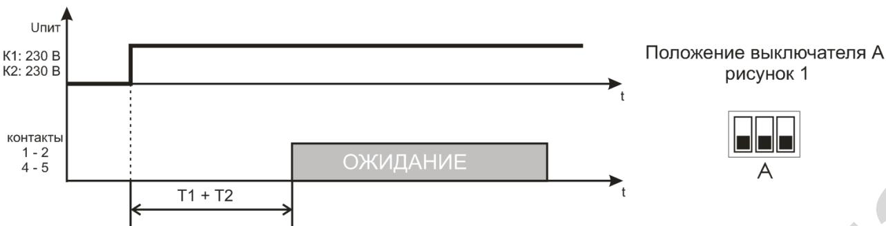
Рисунок 2 – Алгоритм работы реле “Задержка на включение”
