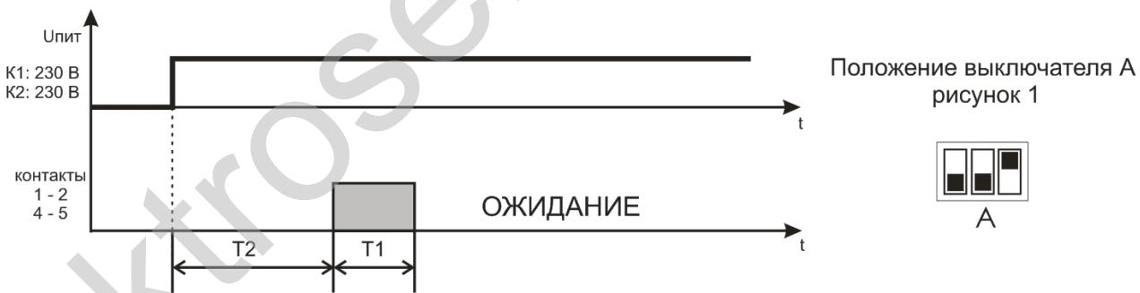
Рисунок 3 – Алгоритм работы реле “Импульсный 1”
